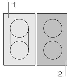
**Вказівка:** В ділянці функції «CombiZone» можна активувати функцію «Powerboost» лише якщо дві конфорки використовуються окремо одна від одної.
