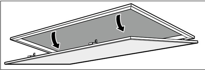
3. Presionar el mecanismo de bloqueo del filtro de metal antigrasa.
