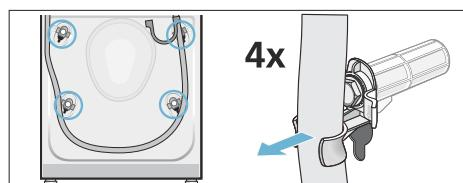
2. Retirez le câble d'alimentation des supports. Dévissez et retirez les quatre vis des sécurités de transport. Retirez les douilles.
