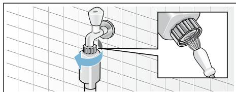
6. Nettoyage du filtre à l'arrière de l'appareil sur les modèles Standard et Aqua-Secure :
