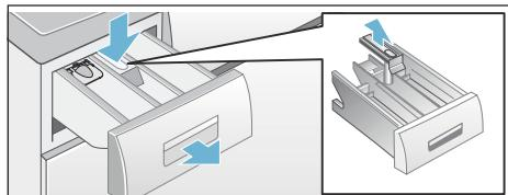
3. Avec de l'eau et une brosse, nettoyez le bac d'introduction du produit et l'insert, puis séchez-le. Éliminer aussi les résidus de produit lessiviel ou de produit assouplissant dans le corps.
