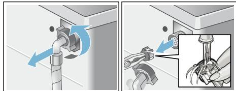
7. Raccorder le flexible et vérifier son étanchéité.
