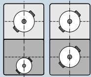
De främre och bakre kokzoner har 2 induktorer var som går att använda oberoende av varandra. Ställ in det effektläge du vill ha på resp. kokzon. Använd bara en gryta på varje kokzon.
