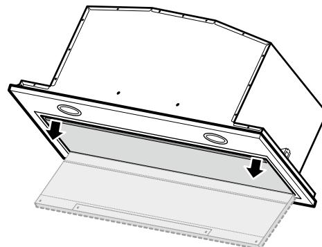
2. Verriegelung öffnen und den Metallfettfilter herunterklappen.
