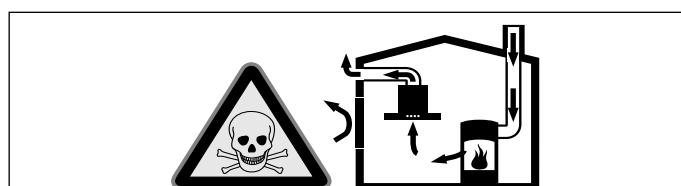
Les foyers à combustion alimentés en air ambiant (par exemple appareils de chauffage, au gaz, au bois, au fioul ou au charbon, les chauffe-eau, chauffe-eau accumulateurs) prélèvent l'air de combustion dans la pièce où ils sont installés et rejettent les gaz de fumée à
