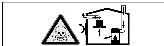
Vuurbronnen die de lucht in de ruimte verbruiken (bijv. apparaten die op gas, olie, hout of kolen worden gestookt, geisers, warmwatertoestellen) trekken de verbrandingslucht uit de opstellingsruimte en voeren de gassen via een afvoer (bijv. schoorsteen) af naar buiten.
