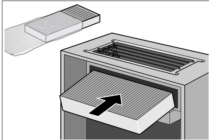
2. Blende so einsetzen, dass sie durch die Magnete sicher gehalten wird.
