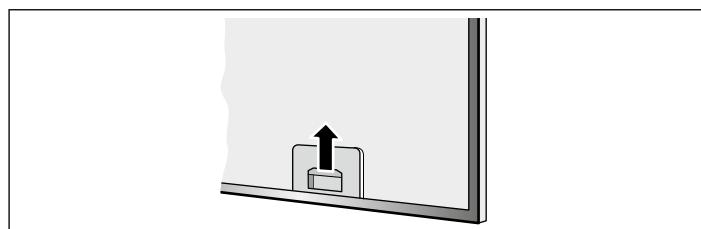
3. Metallfettfilter aus der Halterung herausnehmen.
