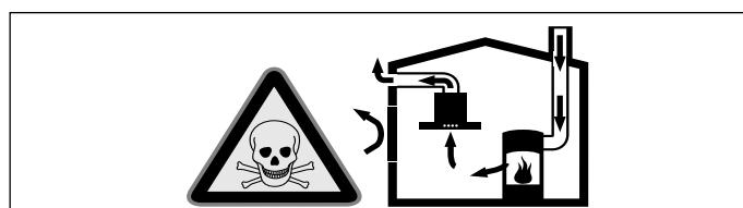
Raumluftabhängige Feuerstätten (z.B. gas-, öl-, holz- oder kohlebetriebene Heizgeräte, Durchlauferhitzer, Warmwasserkessel) beziehen Verbrennungsluft aus dem Aufstellraum und führen die Abgase durch eine Abgasanlage (z.B. Kamin) ins Freie.
