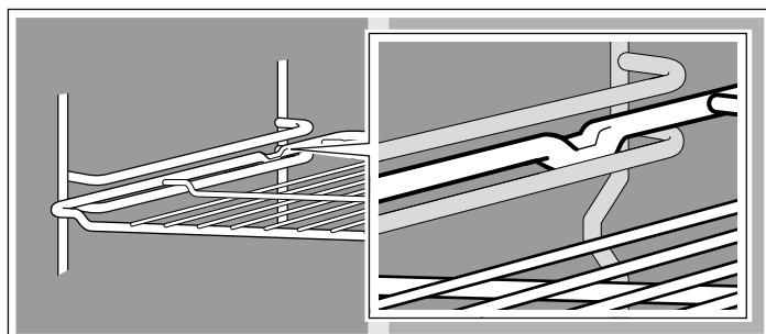
V závislosti na vybavení má spotřebič výsuvné kolejnice, které mírně zaskočí, když je úplně vytáhnete. Tak na ně lze snadno umístit příslušenství. Pro odblokování zatlačte výsuvné kolejnice mírným tlakem zpět do pečící trouby.
