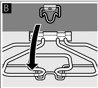
Po skončení čištění vraťte topné těleso grilu zpět směrem nahoru. Zatáhněte za úchyt směrem dolu a topné těleso grilu zavcvakněte.
