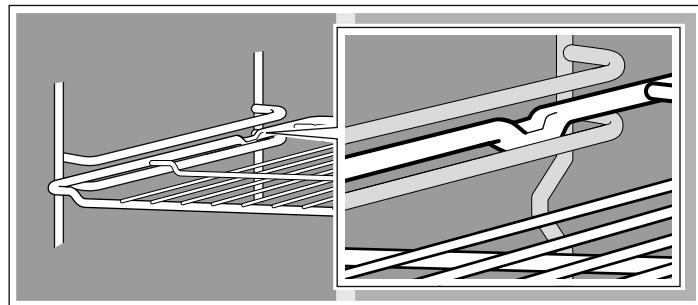
V závislosti od výbavy má spotrebič vyťahovacie koľajničky, ktoré ľahko zapadnú, keď sú celkom vytiahnuté. Príslušenstvo sa tak dá ľahko vložiť dnu. Vyťahovacie koľajničky odblokujete tak, že ich slabým tlakom posuniete znova do rúry.
