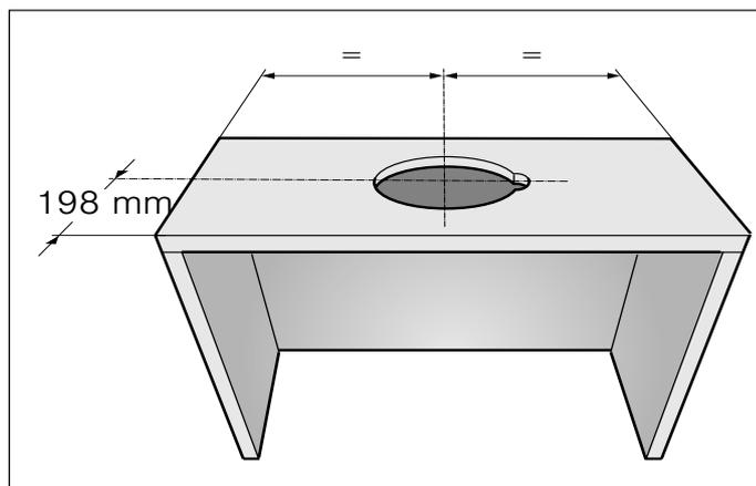
2. Ако е наличен, свалете дъното на шкафа. Маркирайте точките за закрепване от вътрешната страна на шкафа и пробийте предварително с щихел. За маркиране на точките за закрепване използвайте приложния елемент за закрепване.
