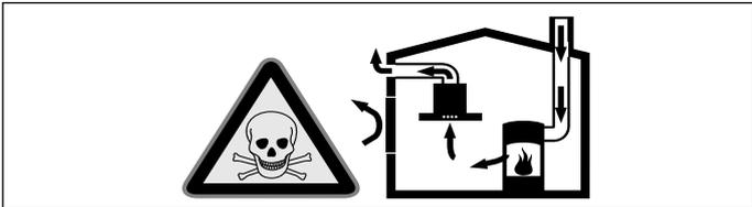
Зависимите от стайния въздух печки (напр. нагревателните уреди, работещи с газ, нафта, дърва или въглища, конвекторните нагреватели, калориферите) изтеглят въздух за изгаряне от мястото на поставяне и изкарват отработени газове през съоръжение за отработени газове (напр. дымоотвод) на открито.
