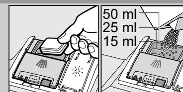
Deterjen harus dimasukkan ke dalam kotak deterjen yang kering.
