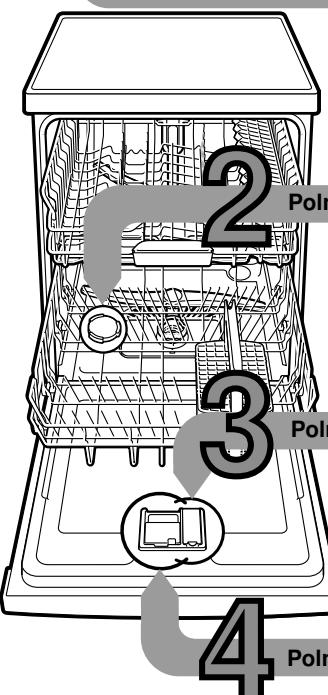
**Poljenje posebne soli****Poljenje sredstva za izpiranje****Poljenje pomivalnega sredstva****Izberite program****Zaženite program****Izklopite stroj**
