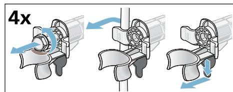
3. Montar las tapas protectoras. Bloquear firmemente las tapas protectoras haciendo presión sobre los ganchos de retención.
