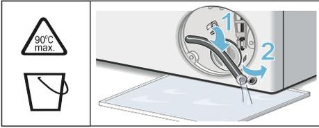
5. Desatornillar con cuidado la tapa de la bomba. Puede haber agua residual. Limpiar el compartimento interior, la rosca de la tapa de la bomba y la carcasa de la bomba. La rueda de aletas de la bomba de desagüe debe moverse. Montar la tapa de la bomba en su sitio y enroscarla. El asidero de la trampilla tiene que estar en posición vertical.
