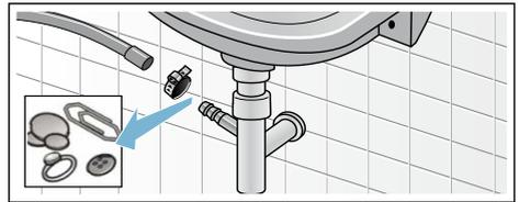
4. Encajar la manguera de desagüe y asegurar los puntos de empalme apretando la abrazadera para manguera.
