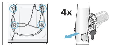
2. Soltar y retirar los 4 tornillos de fijación del transporte. Retirar los manguitos. Retirar para ello el cable de conexión de los fijadores.
