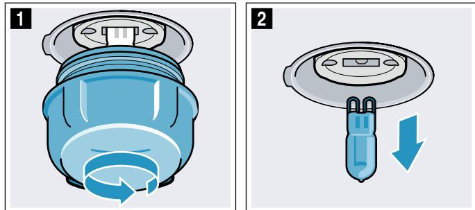
4. Скляний захисний ковпак вкрутіть на місце. Залежно від типу приладу скляний захисний ковпак оснащено ущільнювальним кільцем. Перед вкручуванням встановіть на місце ущільнювальне кільце.
