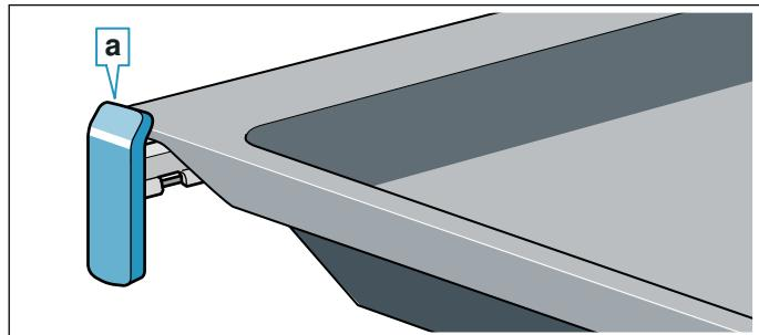
Висувні рейки фіксуються, коли вони повністю витягнуті. Це полегшує встановлення приладдя в прилад. Для розблокування напрямних шин всуньте їх легким натисненням назад у робочу камеру.
