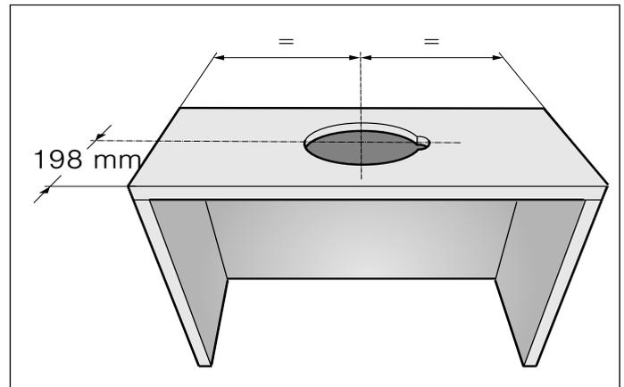
2. Falls vorhanden, Schrankboden entfernen. Befestigungspunkte an den Schrankinnenseiten anreißen und mit einem Stichel vorstechen. Zum Anreißen der Befestigungspunkte das beiliegende Befestigungsteil verwenden.
