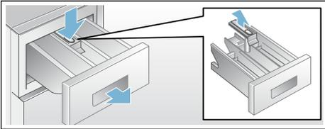
3. Einspülschale und Einsatz mit Wasser und Bürste reinigen und abtrocknen. Auch Gehäuse innen reinigen.
