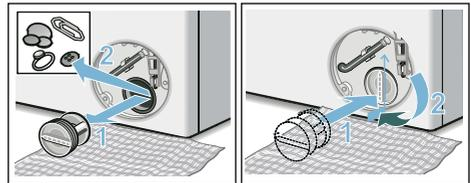
6. Service-Klappe einsetzen, einrasten und schließen.
