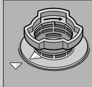
Kierrä siiviläjärjestelmä kiinni! **HUOMIOI MERKIT!**
