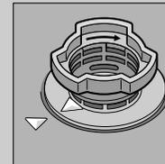
Kierrä siiviläjärjestelmä kiinni
