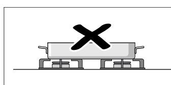
Nie należy używać dwóch palników lub dwóch źródeł ciepła dla jednego naczynia. Unikać dłuższego używania płyt do grillowania, garnków z kamionki, itd., wykorzystując maksymalną moc urządzenia.
