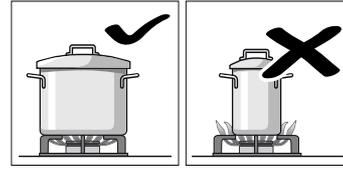
Χρησιμοποιήστε σκεύη κατάλληλου μεγέθους για κάθε καυστήρα. Να μη χρησιμοποιείτε μικρά σκεύη πάνω σε μεγάλους καυστήρες. Η φλόγα δεν πρέπει να αγγίζει τα πλευρικά τοιχώματα του σκεύους.
