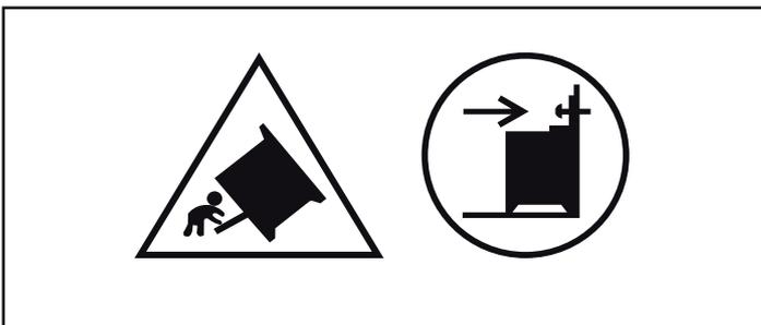
**Warnung:** Um ein Umkippen des Gerätes zu vermeiden, muss dieses Stabilisierungsmittel montiert werden. Für die Montage siehe Anweisungen.
