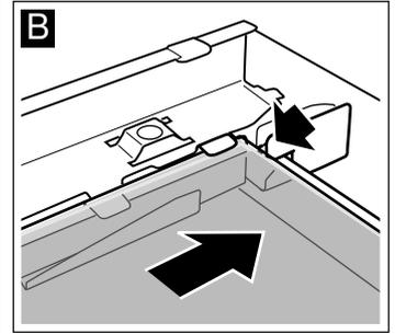
3. Haltefedern rechts und links auf der oberen Scheibe so anbringen, dass die Federn über dem Schraubloch sind. Beide Federn wieder festschrauben (Bild C).
