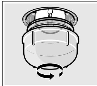
3. Lampe durch den gleichen Lampentyp ersetzen.
