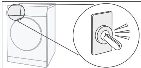
L'eau de condensation est pompée dans le réservoir d'eau de condensation par une pompe. Des bruits de pompage se font donc entendre.
