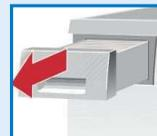
Wenn Anzeigelampe **(Kondenswasserbehälter)** trotz Entleeren blinkt → Filter im Kondenswasserbehälter reinigen, Seite 8/12.
