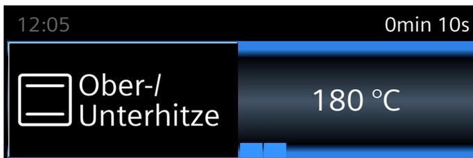
Im Display wird die eingestellte Heizart und die Temperatur angezeigt.
