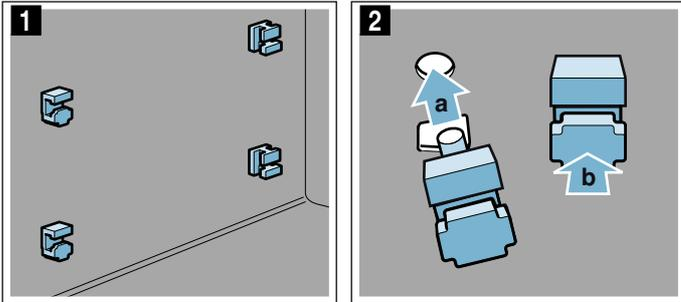
3. Die Halterung hinten mit dem Haken in das obere Loch einhängen **a** und in das untere Loch eindrücken **b** (Bild **3**).
