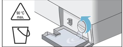
6. Pumpendeckel vorsichtig abschrauben, Restwasser kann auslaufen. Innenraum, Gewinde des Pumpendeckels und Pumpengehäuse reinigen. Das Flügelrad der Laugenpumpe muss sich drehen lassen. Pumpendeckel wieder einsetzen und verschrauben. Griff muss senkrecht stehen.
