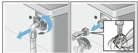
7. Schlauch anschließen und auf Dichtigkeit prüfen.
