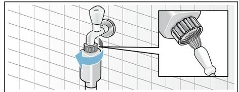
6. Bei Modellen Standard und Aqua-Secure Sieb an der Geräterückseite reinigen: Schlauch an der Geräterückseite abnehmen, Sieb mit Zange herausnehmen und reinigen.
