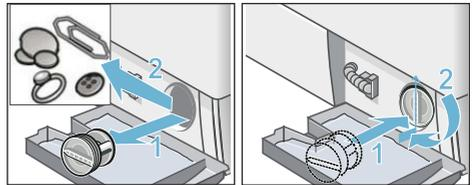
7. Service-Klappe einsetzen, einrasten und schließen.
