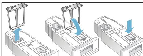
8. Inserire il contenitore dell'acqua di condensa fino all'arresto.
