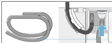
5. Fissare il tubo di scarico dall'altro lato agli altri accessori a seconda della tipologia di allacciamento A, B o C.
