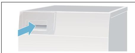
**Avvertenza:** Il filtro nel contenitore dell'acqua di condensa filtra l'acqua di condensa che viene utilizzata per la pulizia automatica dell'asciugatrice. Svuotando l'acqua di condensa il filtro viene pulito. Ciononostante controllare regolarmente che non ci siano depositi di impurità nel filtro. In caso contrario, rimuoverli. Vedere → *Pagina 37.*
