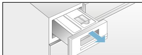
7. Estrarre il filtro dallo scomparto e inserirlo nell'incavo del contenitore dell'acqua di condensa.
