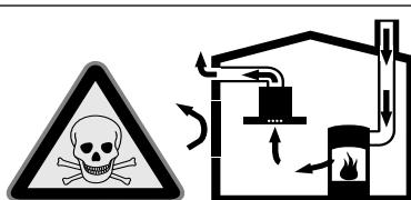
Ildsteder, hvis lufttilførsel sker fra indeluften, (f.eks. gas-, olie-, træ- eller kulfyrede varmeapparater, gennemstrømningsvandvarmere, vandvarmere) henter deres forbrændingsluft fra opstillingsrummet og fører røggassen ud gennem en røggaskanal(f.eks. skorsten) til det fri.
