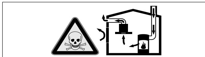
Ildsteder som er avhengig av romluft (f.eks. varmeapparater som drives med gass, olje eller kull, varmvannsberedere) bruker forbrenningsluften fra oppstillingsrommet og leder avgassene gjennom et avgassanlegg (f.eks. pipe) i det fri.
