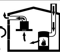
Eldstäder som är beroende av rumsluft (t.ex. värmeapparater som drivs med gas, olja, ved eller kol, genomströmningsapparater, varmvattenberedare) tar sin förbränningsslut ur det utrymme där enheten är installerad och leder ut avgaserna i det fria via en avgasanläggning (t.ex. skorsten).
