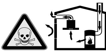
Huoneilmaa tarvitsevat tulisijat (esim. kaasu-, öljy-, puu- tai hiilikäytöiset lämmityslaitteet, läpivirtauskuumennin, vedenkuumennin) ottavat poistoilman huonetilasta ja johtavat poistoilman poistoilmalaiteen (esim. savutorven) kautta ulos. Tuuletin imkeelee ja sen viereisistä huoneista ilmaa - tämä on korvattava riittäväällä tuloilmallla - muutoin syntyy alipaine. Myrkylliset kaasut imetyisivät takaisin huoneisiin savutorvesta tai poistoilmakanavasta.
