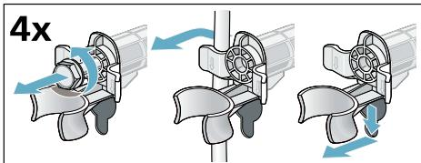
3. Colocar as tampas. Encaixar bem as tampas, pressionando nos ganchos de encaixe.
