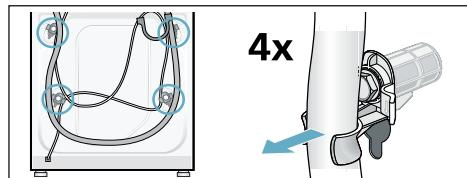
2. Desapertar todos os 4 parafusos do dispositivo de segurança para transporte e retirá-los.
