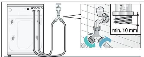
**Conselho:** Abrir cuidadosamente as mangueiras de água e verificar a estanqueidade dos pontos de ligação. A união rosada está sob pressão do sistema de abastecimento de água.
