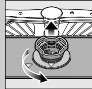
Rodar o filtro cilíndrico e retirar o sistema de filtros ...
