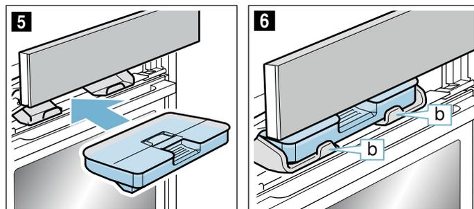
9. Pousser lentement le bandeau vers le bas, puis l'enfoncer vers l'arrière jusqu'à ce qu'il soit entièrement fermé. Le réservoir d'eau est rempli. Vous pouvez démarrer des modes avec de la vapeur.
