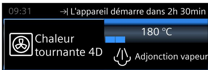
Le four est en position d'attente. Le symbole →| et l'heure à laquelle le fonctionnement sera terminé apparaissent dans la ligne d'état. Le fonctionnement démarre au moment approprié. La durée s'écoule visiblement dans la ligne d'état.
