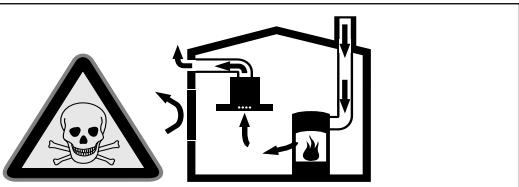
Ildsteder som er avhengig av romluft (f.eks. varmeapparater som drives med gass, olje eller kull, varmtvannsberedere) bruker forbrenningsluften fra oppstillingsrommet og leder avgassene gjennom et avgassanlegg (f.eks. pipe) i det fri.
