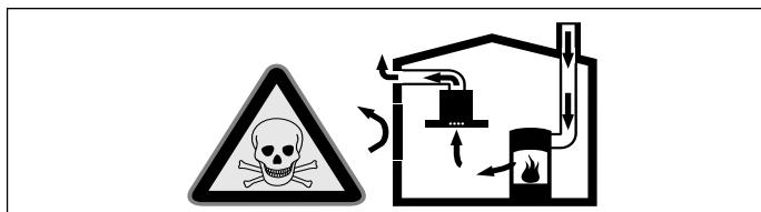
Kuhališča, ki so odvisna od prostorskega zraka (npr. grelne naprave na plin, olje, les ali oglje, pretočni grelniki, bojlerji), jemljejo zrak za izgorevanje iz prostora postavitve in odvajajo dim prek sistema za odvajanje dima (npr. napa) na prosto.
