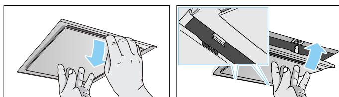
Pri dodatnih filtrihih v notranjosti odprite zaklep in preklopite kovinski maščobni filter navzdol. Pri tem primite z drugo roko pod kovinski maščobni filter.
