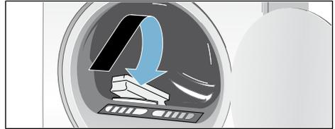
Tür öffnen und Feuchtigkeitsfühler mit einem angerauchten Schwamm reinigen.
