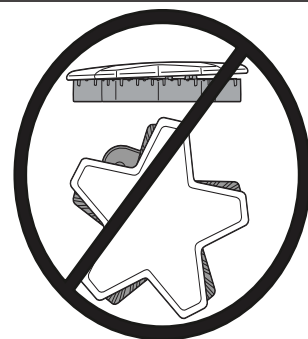
Positionnement incorrect de la cuvette du brûleur
