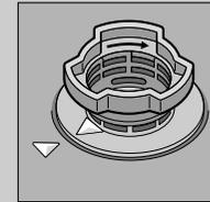
kierrä siiviläjärjestelmä kiinni. HUOMIO! MERKIT!
