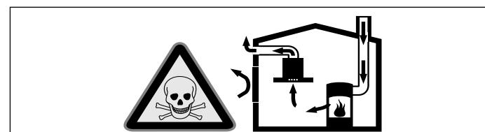
Raumlufthängige Feuerstätten (z.B. gas-, öl-, holz- oder kohlebetriebene Heizgeräte, Durchlauferhitzer, Warmwasserbereiter) beziehen Verbrennungsluft aus dem Aufstellraum und führen die Abgase durch eine Abgasanlage (z.B. Kamin) ins Freie.
