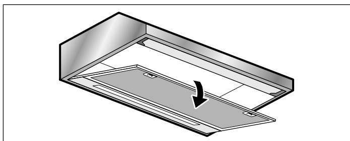
3. Filtergitter schräg positionieren und abnehmen.
