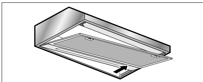
4. Drähte entfernen und Vlies-Fettfilter entnehmen.
