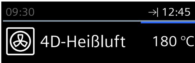
Der Backofen ist in Warteposition. In der Statuszeile erscheint das Symbol →| und die Zeit, wann der Betrieb fertig ist. Der Betrieb startet zum richtigen Zeitpunkt. Die Dauer läuft sichtbar in der Statuszeile ab.
