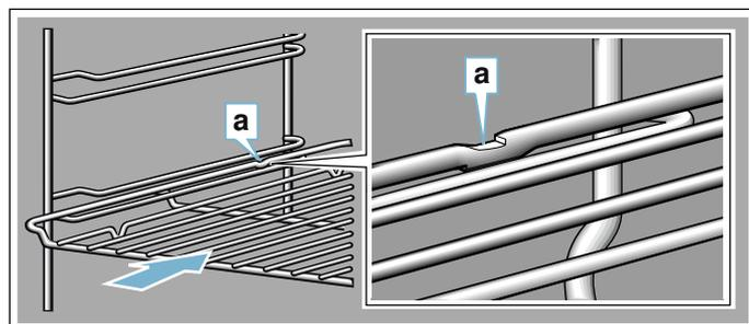
Achten Sie beim Einschieben von Blechen darauf, dass die Rastnase **a** hinten ist und nach unten zeigt. Die Abschrägung des Zubehörs **b** muss vorne zur Gerätetür zeigen.
