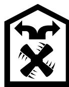
Liesituulettimen imemä ilma palautetaan rasvasuodattimien ja aktiivihiihdisuodattimien puhdistamana takaisin keittiöön.
