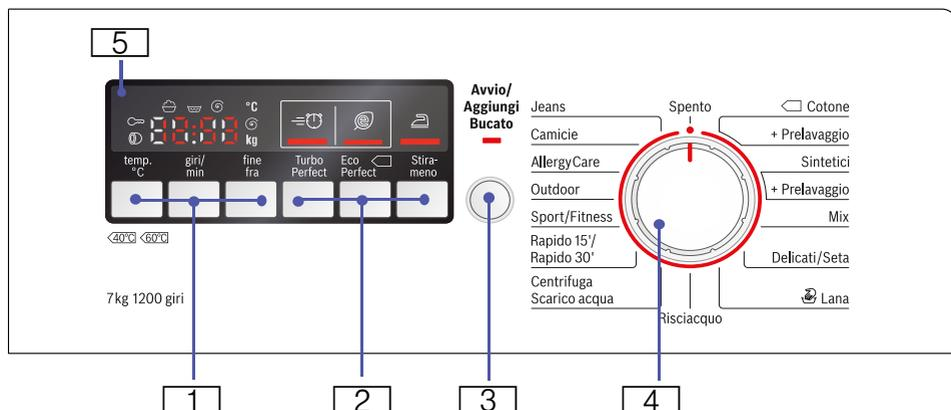
1 temp. °C (Temperatura), giri/min (velocità di centrifuga), fine fra per la modifica delle preimpostazioni del programma
