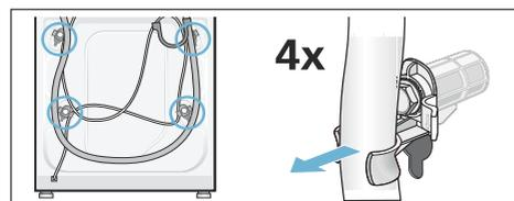
2. Svitare e rimuovere tutte le 4 viti dei blocchi per il trasporto. Rimuovere le boccole. Staccare il cavo di alimentazione dai fermi.
