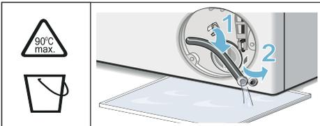
5. Svitare con cautela il coperchio della pompa, l'acqua residua può fuoriuscire. Pulire l'interno, la filettatura del coperchio della pompa e il corpo della pompa. Deve essere possibile ruotare il girante della pompa di scarico. Applicare di nuovo il coperchio della pompa e serrarlo a fondo. L'impugnatura deve essere in posizione verticale.
