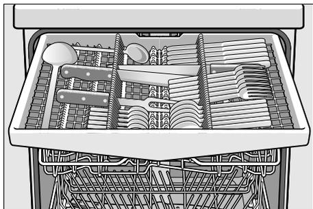
Selon le modèle, il est possible de replier vers le bas les supports latéraux afin d'offrir de la place aux couverts plus grands. Les rangées avant de tiges peuvent être repliées pour pouvoir ranger triées les poignées plus larges.
