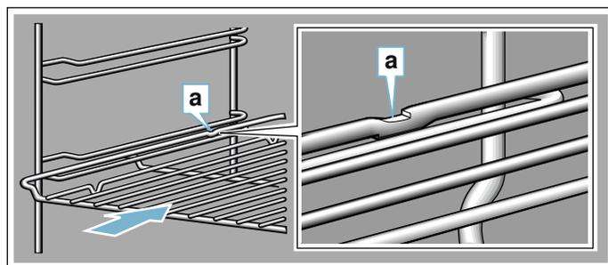
En introduisant des plaques, veillez à ce que le taquet d'arrêt **a** soit à l'arrière et orienté vers le bas. La partie inclinée de l'accessoire **b** doit être orientée vers l'avant en direction de la porte de l'appareil.
