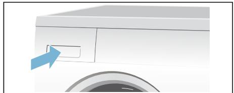
**Hinweis:** Das Sieb im Kondenswasser-Behälter filtert das Kondenswasser, das zur automatischen Reinigung Ihres Trockners verwendet wird. Das Sieb wird durch Entleeren des Kondenswassers gereinigt. Prüfen Sie das Sieb trotzdem regelmäßig auf verbliebene Ablagerungen und entfernen diese. Siehe → Seite 22.
