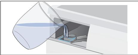
5. Gießen Sie destilliertes Wasser mit der mitgelieferten Kanne in die Einfüllöffnung des Refresher-Tankes, bis im Anzeigefeld
