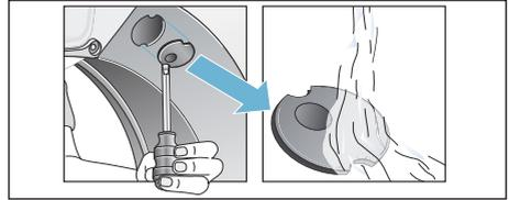
1. Tür öffnen und die Abdeckung der Dampfdüse mit einem Schraubenzieher entfernen.
