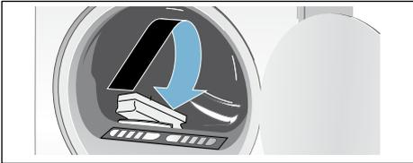
Tür öffnen und Feuchtigkeitsfühler mit einem angerauten Schwamm reinigen.
