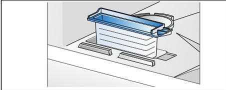
2. Entnehmen Sie das Sieb und reinigen es unter fließendem Wasser oder in der Geschirrspülmaschine.
