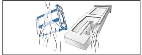
5. Setzen Sie das Sieb bis zum fühlbaren Einrasten ein.
