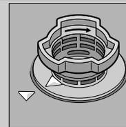
Kierrä siiviläjärjestelmä kiinni
