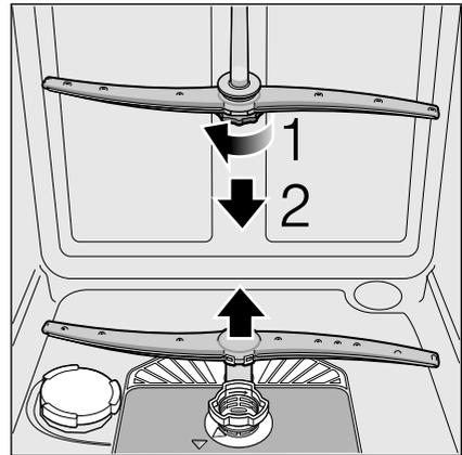
4. Sprüharme unter fließendem Wasser reinigen.
