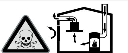
Les foyers à combustion alimentés en air ambiant (par exemple appareils de chauffage, au gaz, au bois, au fioul ou au charbon, les chauffe-eau, chauffe-eau accumulateurs) prélèvent l'air de combustion dans la pièce où ils sont installés et rejettent les gaz de fumée à l'extérieur par le biais d'un système spécifique (cheminée par exemple).
