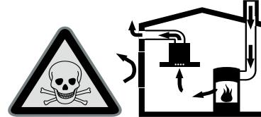
Vuurbronnen die de lucht in de ruimte verbruiken (bijv. apparaten die op gas, olie, hout of kolen worden gestookt, geisers, warmwaterinstallaties) trekken de verbrandingslucht uit de opstellingsruimte en voeren de gassen via een afvoer (bijv. schoorsteen) af naar buiten.
