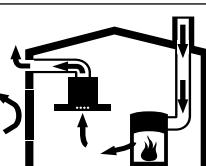
Uzavřené spotřebiče paliv (např. tepelné spotřebiče na plyn, olej, dřevo nebo uhlí, průtokové ohříváče, bojler) odebírají spalovací vzduch z místnosti, ve které jsou nainstalované, a spaliny odvádějí zařízením pro odvod spalin (např. komínem) ven.
