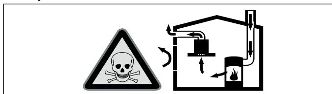
Kurišča, odvisna od zraka v prostoru (npr. grelne naprave na plin, olje, les ali premog, pretočni grelníki, bojlerji) črpajo zrak za izgorevanje iz prostora, v katerem so nameščeni, in odvajajo izpušne pline prek sistema za odvajanje plinov (npr. dimnik) na prosto.
