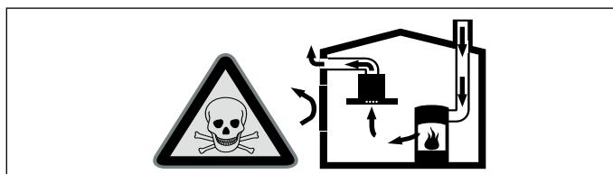
I focolari che dipendono dall'aria ambiente (peres. a gas, olio, legna o carbone, scaldabagno, caldaie elettriche) ricavano l'aria per la combustione dalla stanza ed eliminano i gas di scarico all'esterno attraverso un impianto (peres. camino).
