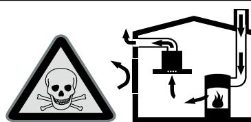
ILDSTEDER SOM ER AVHENGIG AV ROMLUFT (F. EKS. Varmeapparater som drives med gass, olje eller kull, varmtvannsberedere) BRUKER FORBRENNINGSLUFSEN FRA OPPSTILLINGSROMMET OG LEDER AVGASSENE GJENNOM ET AVGASSANLEGG (F. EKS. PIPE) I DET FRI.
