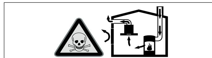
Os equipamentos de aquecimento que consomem o ar ambiente (p.ex. sistemas de aquecimento a gás, óleo, lenha ou carvão, esquentadores, cilindros) utilizam para a combustão o ar do local de montagem e transportam os gases de combustão para o exterior através de um sistema de exaustão (p.ex. uma chaminé).
