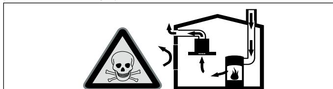
Hava dolaşımı ateşlikler (örneğin gaz, yağ, odun veya kömürle çalışan sobalar, şöfbenler, su ısıtıcıları) yanma havasını kurulum yerinden alırlar ve atık gazi bir atık gaz sistemi (örneğin baca) kanalıyla dışarıya aktarırlar.
