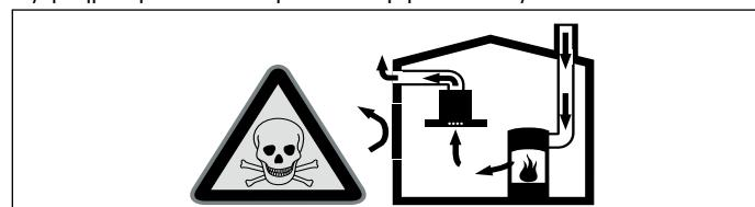
Εστίες, εξαρτημένες από τον αέρα του περιβάλλοντος (π.χ. συσκευές θέρμανσης που λειτουργούν με αέριο, πετρελαιο, ξύλο ή άνθρακα, ταχυθερμοσίφωνες, θερμαντήρες νερού) λαμβάνουν τον αέρα για καύση από το χώρο τοποθέτησης και οδηγούν τα καυσαέρια μέσα από μια εγκατάσταση απαγωγής των καυσαερίων (π.χ. καυνίδα) στον έξω χώρο.
