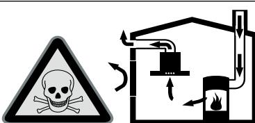
Los equipos calefactores que dependen del aire del recinto de instalación (p. ej., calefactores de gas, aceite, madera o carbón, calentadores de salida libre, calentadores de agua) adquieren aire de combustión del recinto de instalación y evacúan los gases de escape al exterior a través de un sistema extractor (p. ej., una chimenea).
