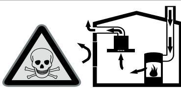
Топки із підведенням повітря із приміщення (напр., опалювальні установки, які працюють на газі, рідкому паливі, дровах чи вугіллі, проточні нагрівачі, бойлери) забирають повітря для горіння палива із приміщення, де вони установлені, а гази, що виділяються при цьому, відходять через витяжну систему (напр., димохід) на вулицю.
