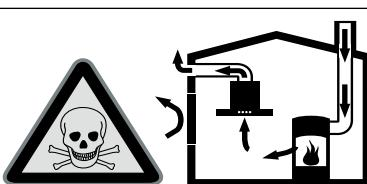
室内空気依存の熱発生機具（ガス、石油、石炭式ヒーター、フローヒーター、湯沸かし器など）は、器具が設置されている部屋から燃焼空気を取得し、排気システム（煙突など）を介して排ガスを外気中に排出します。
