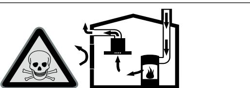
Ohniská závislé od vetrania miestnosti (napr. vyhrievacie prístroje na plyn, olej, drevo alebo uhlí, prietokové ohrievače, ohrievače vody) odberajú dymové plyny z miestnosti, kde sú nainštalované a odvádzajú ich odsávacím zariadením (napr. komín) von.
