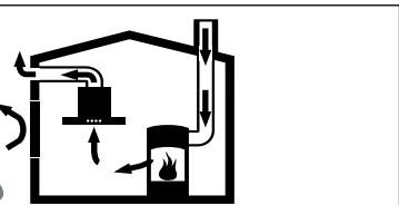
Zależne od powietrza w pomieszczeniu urządzenia spalające (np. grzejniki na gaz, olej, drewno lub węgiel, przepływowe podgrzewacze wody i inne podgrzewacze wody) pobierają powietrze do spalania z pomieszczenia, w którym się znajdują, a spalinę odprowadzają przez układ wylotowy (np. komin) na zewnątrz.
