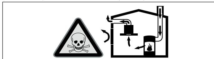
Vatrišta koja zavise od vazduha u prostoriji (npr. grejni uredaji na gas, ulje, drvo ili ugalj, protočni bojleri, kotlovi za zagrevanje vode) vazduh za sagorevanje crpe iz prostorije u koju su postavljeni i izdutive gasove izbacuju preko sistema za izdutive gasove (npr. kamoin) u spoljašnju sredinu.
