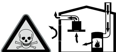
Ildsteder, hvis lufttilførsel sker fra indeluftten, (f.eks. gas-, olie-, træ- eller kulfyrede varmeapparater, gennemstrømningsvandvarmere, vandvarmere) henter deres forbrændingsluft fra opstillingsrummet og fører røggassen ud gennem en røggaskanal(f.eks. skorsten) til det fri.
