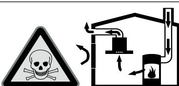
Eldständer som är beroende av rumsluft (t.ex. värmearrapparater som drivs med gas, olja, ved eller kol, genomströmningsapparater, varmvattenberedare) tar sin förbränningsslutur ur det utrymme där enheten är installerad och leder ut avgaserna i det fria via en avgasanläggning (t.ex. skorsten).
