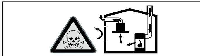
Huoneilmaa tarvitsevat tulisijat (esim. kaasu-, öljy-, puu- tai hiilikäyttöiset lämmityslaitteet, läpivirtauskuumennin, vedenkuumennin) ottavat poltoilman huonetilasta ja johtavat poltoilman poistoilmalaiteen (esim. savutorven) kautta ulos. Tuuletin imee keittiöstä ja sen viereisistä huoneista ilmaa - tämä on korvattava riittävällä tuloilmallla - muutoin syntyy alipaine. Myrkylliset kaasut imetyisivät takaisin huoneisiin savutorvesta tai poistoilmakanavasta.
