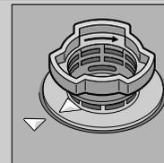
Kierrä siiviläjärjestelmä kiinni
