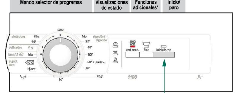
ⓘ Mando selector de programas para conectar y desconectar la máquina, y para seleccionar un programa de lavado. El mando se puede girar en ambas direcciones.
