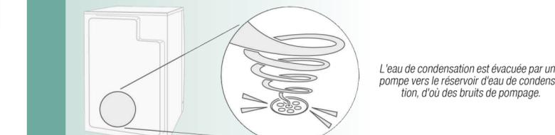
L'eau de condensation est évacuée par une pompe vers le réservoir d'eau de condensation, d'où des bruits de pompage.
