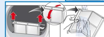
5. Beide Teile unter fließendem Wasser durchspülen und gut abtrocknen.
