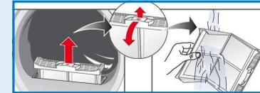
2. Beide Teile des Flusensiebes herausziehen.
