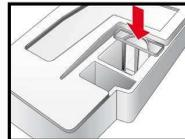
5. Kondenswasserbehälter einschieben bis zum Einrasten.
