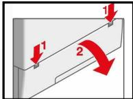
5. Luftkühler entfernen.
