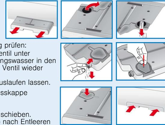
Ventil im Kondenswasserbehälter auf Verunreinigung prüfen: Sollten sich Flusen am Ventil abgesetzt haben → Ventil unter fließendem Wasser abspülen. Zusätzlich etwas Leitungswasser in den leeren Kondenswasserbehälter füllen und durch das Ventil wieder entleeren.
