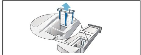
4. Lavare il filtro sotto l'acqua corrente calda oppure in lavastoviglie.
