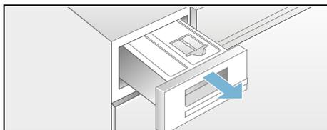
7. Estrarre il filtro dallo scomparto e inserirlo nell'incavo del contenitore dell'acqua di condensa.
