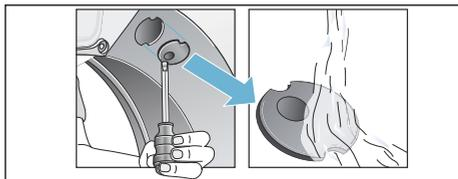
1. Aprire lo sportello e rimuovere la copertura dell'ugello vapore con un cacciavite.
