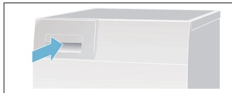
**Avvertenza:** Il filtro nel contenitore dell'acqua di condensa filtra l'acqua di condensa che viene utilizzata per la pulizia automatica dell'asciugatrice. Svuotando l'acqua di condensa il filtro viene pulito. Ciononostante controllare regolarmente che non ci siano depositi di impurità nel filtro. In caso contrario, rimuoverli. Vedere → *Pagina 35*.
