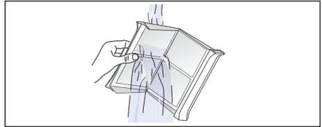
7. Asciugare i filtri per lanugine, chiuderlo e reinserire il filtro per lanugine a due componenti.
