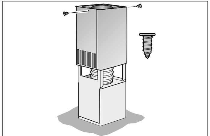
5. Colocar las dos piezas inferiores de la chimenea y unir las entre sí.
