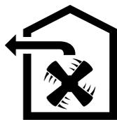
O ar aspirado é limpo na sua passagem pelo filtro de gordura e encaminhado para o exterior através de um sistema de tubagem.
