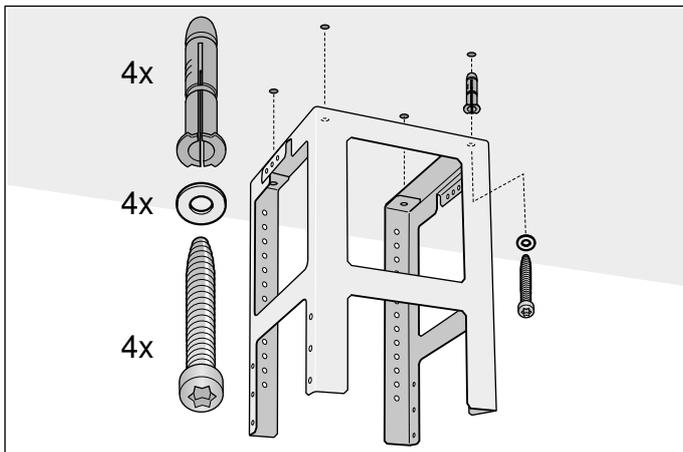
4. Fazer quatro furos com (diâmetro) 8 mm e 80 mm de profundidade para as fixações e introduzir as buchas à face
