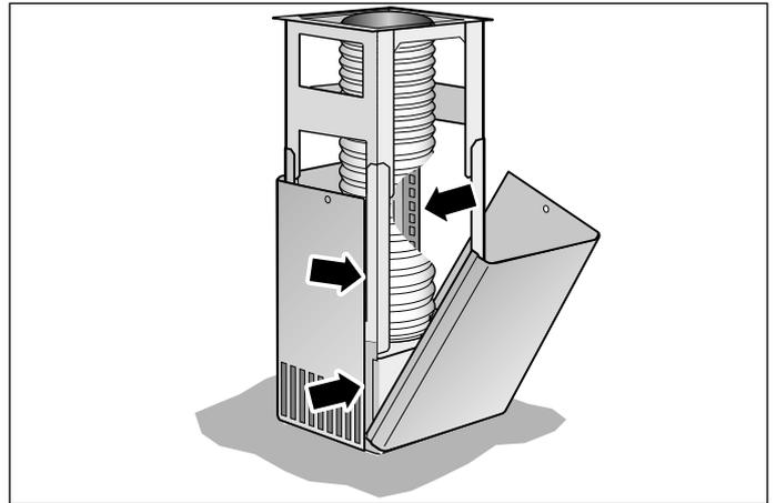
4. Deslizar hacia arriba la parte superior de la chimenea y fijarla con 2 tornillos.
