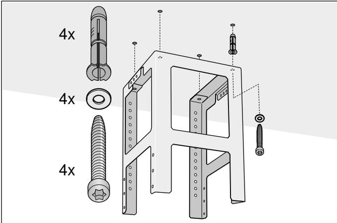
4. Taladrar cuatro orificios con un diámetro de 8 mm y una profundidad de perforación de 80 mm para las fijaciones y seguidamente introducir los tacos de tal manera que queden enrasados
