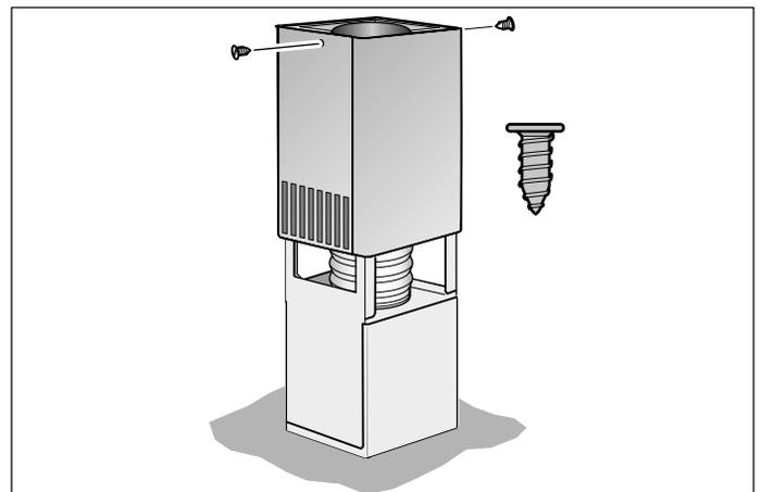
5. Aplicar as duas partes inferiores da chaminé e encaixá-las.
