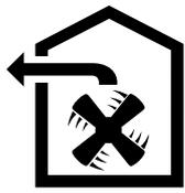
El aire aspirado se depura a través de filtros antigrasa y se evacua al exterior mediante un sistema de tubos.
